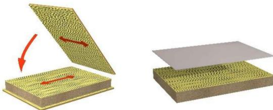
Idealerweise wird der Klebstoff kreuzweise aufgetragen. Holzleisten sind hilfreich bei großflächigen Beschichtungen (siehe Abbildung).
