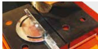
VARIABLE WINKELSCHNITTFÜHRUNG MIT GRADSKALA
